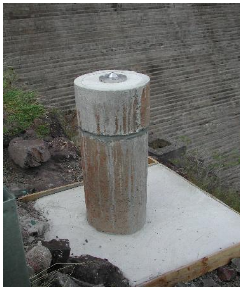
FIGURA 4. Pilar com o Sistema de Centragem Forçada.
