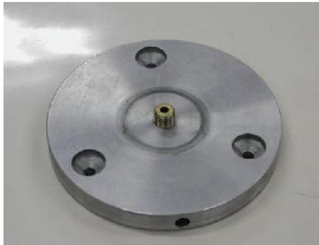
FIGURA 5. Detalhe do Sistema de Centragem Forçada.
